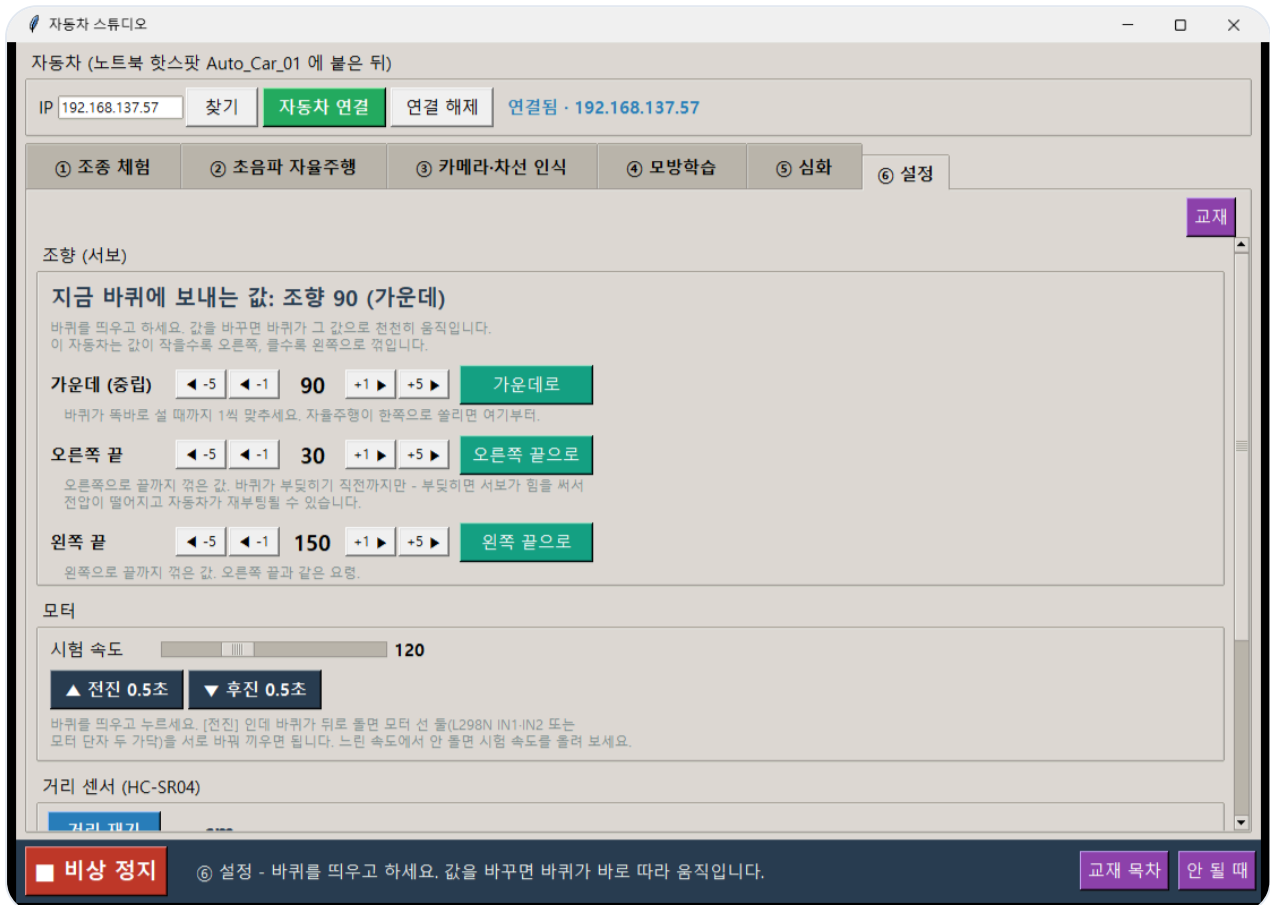
⑥ 설정 탭. 조향 가운데 · 오른쪽 끝 · 왼쪽 끝, 모터 시험, 거리 재기 (screen_tab6_setup.png)
